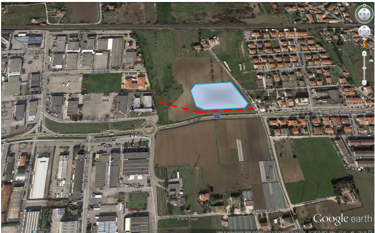
Figura 3: Ortofoto area oggetto di realizzazione della cassa di espansione; la linea rossa tratteggiata indica il sedime del collettore fognario (fognatura mista) esistente che fungerà da recapito dello scarico di fondo della vasca stessa.
